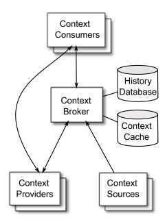
Figure 3.1.: C-CAST CMF – Architecture Components
