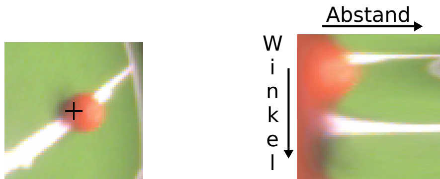
Abbildung 3: Ein Beispielbild in Originalform (links) und in Polarkoordinaten (rechts). Die Position des Pols des Polarkoordinatenbilds ist mit einem Kreuz im Originalbild markiert.
