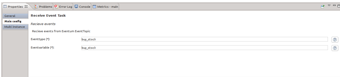
Abbildung 8.3.: Benutzungsoberfläche zur Konfiguration der Receive Event Task - Es wird festgelegt, auf welches Ereignis gewartet werden soll, und wie der Bezeichner der Variable heißen soll, die nach dem Empfang die Ereignisdaten enthält.
