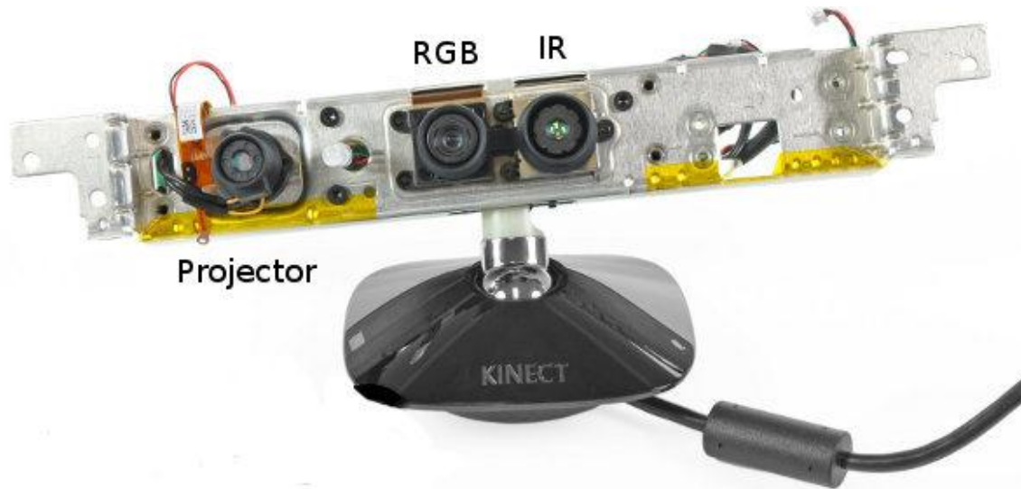
Abbildung 1: Kinect ohne Gehäuse mit Bezeichnung der Bildkomponenten 3
