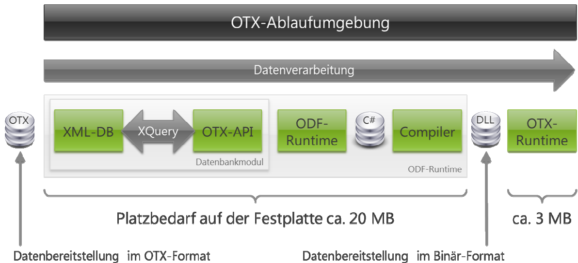
Abb. 12: Ablauf der OTX Runtime [8]:
