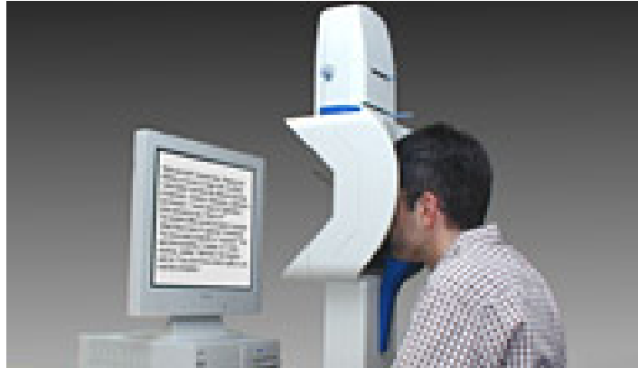
Abbildung 2.9.: Kinnstützen-Eye-Tracker: Um Kopfbewegungen während der Studie zu minimieren, stützt der Proband seinen Kopf auf eine Kinnstütze. Stimuli werden auf dem Bildschirm vor dem Probanden angezeigt und die Augenbewegungen des Probanden werden erfasst [23].
