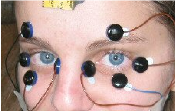
Abbildung 2.8.: Beispiel für Elektro-Okulographie: An den Stellen, wo Elektroden platziert werden, können Unterschiede im elektrischen Potenzial der Haut erkannt werden, wenn die Augen bewegt werden. Dadurch lassen sich die Augenbewegungen feststellen [1].
