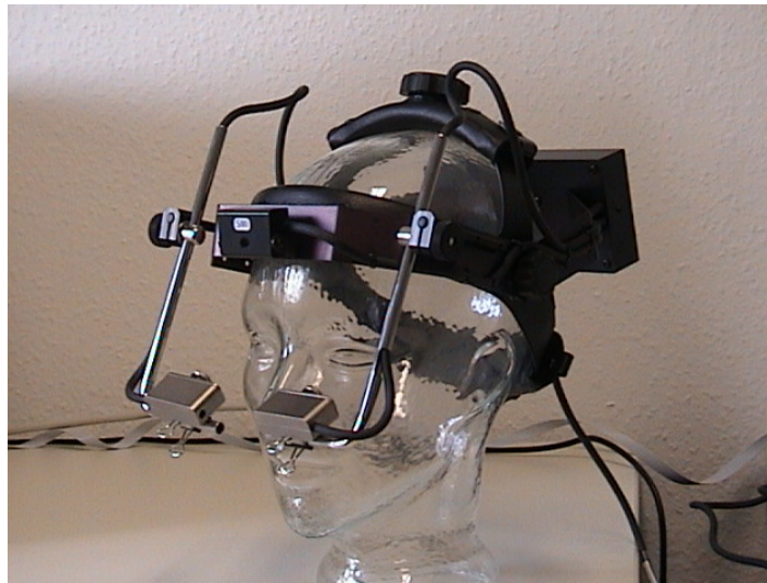
Abbildung 2.10.: Kopfgetragene Eye-Tracker: Die Kamera auf dem Gerät filmt das Blickfeld des Probanden. Zwei weitere Kameras richten sich jeweils auf ein Auge und erfassen die relative Blickposition zur Kopfausrichtung [20].
