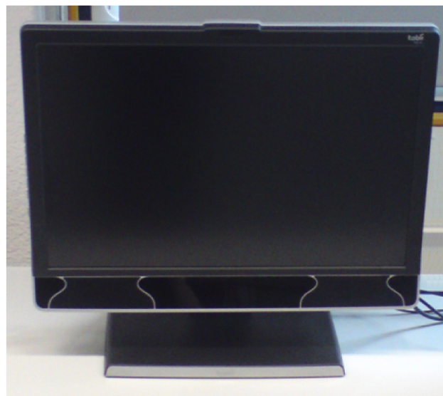
Abbildung 2.11.: Remote-Eye-Tracker: Links im Bild wird ein Beispiel eines Eye-Trackers gezeigt. Der Monitor wird mit einer Video-Kamera und zwei Infrarot-LEDs ausgerüstet. Die beiden Infrarot-LEDs erzeugen die Reflexionen auf der Oberfläche der Augenhornhaut und die Video-Kamera filmt die Augenbewegungen [4]. Rechts im Bild ist der in dieser Diplomarbeit eingesetzte Eye-Tracker zu sehen: Tobii T60 XL.
