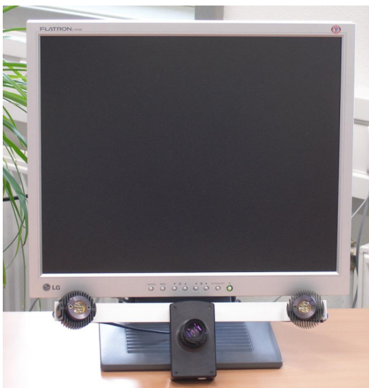
Abbildung 2.11.: Remote-Eye-Tracker: Links im Bild wird ein Beispiel eines Eye-Trackers gezeigt. Der Monitor wird mit einer Video-Kamera und zwei Infrarot-LEDs ausgerüstet. Die beiden Infrarot-LEDs erzeugen die Reflexionen auf der Oberfläche der Augenhornhaut und die Video-Kamera filmt die Augenbewegungen [4]. Rechts im Bild ist der in dieser Diplomarbeit eingesetzte Eye-Tracker zu sehen: Tobii T60 XL.
