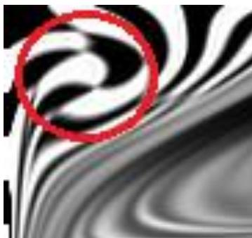
Abbildung 7-7: Artefakte, welche durch das Polynom fünften Grades erstellt werden. Diese sind nur bei sehr großen Schrittzahlen erkennbar. Als Vektorfeld wird `high_viscosity.dat` verwendet und 250 Schritte berechnet.
