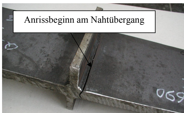
Bild 6.35: Bruch Großprüfkörper (QS3) Anrissbeginn am Nahtübergang (S690, im Schweißzustand belassen, R = 0,1 )
