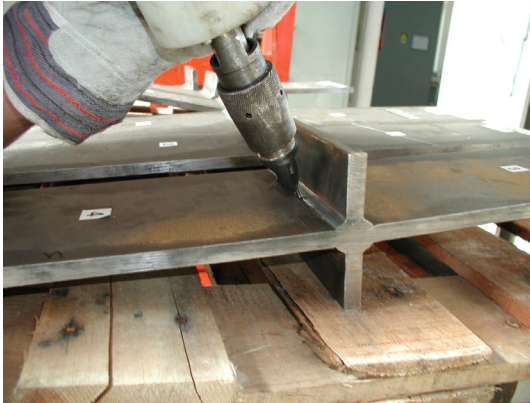
Bild 6.6: UIT-Behandlung der Klein- und Großprüfkörper
