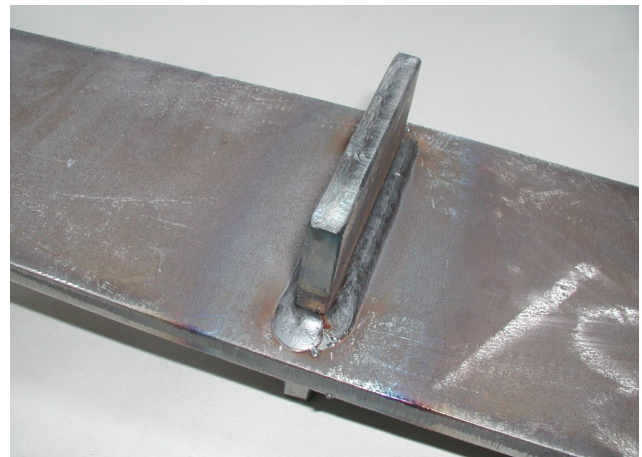
Bild 6.4: Großprüfkörper (QS 6) mit Schweißnahtansatzstellen
