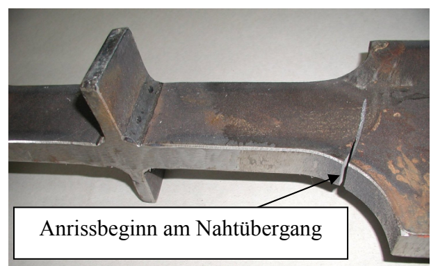
Bild 6.36: Bruch Großprüfkörper (QS4) Anriss am radialen Übergang der Schenkelprobe (S690, UIT-Verfahren, R = 0,1 )
