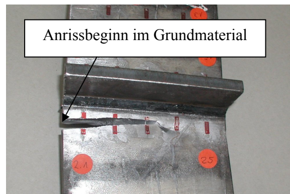
Bild 6.28: Bruch Großprüfkörper (QS2) mit Anrissbeginn im Grundmaterial (S690, UIT-Verfahren, R = 0,1)
