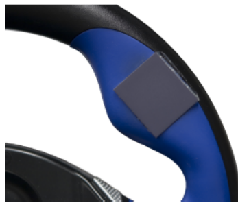
Abbildung 2.10.: Auf dem Lenkrad befestigtes Touchpad zur Gesteneingabe mit dem rechten Daumen (Quelle: [25])
