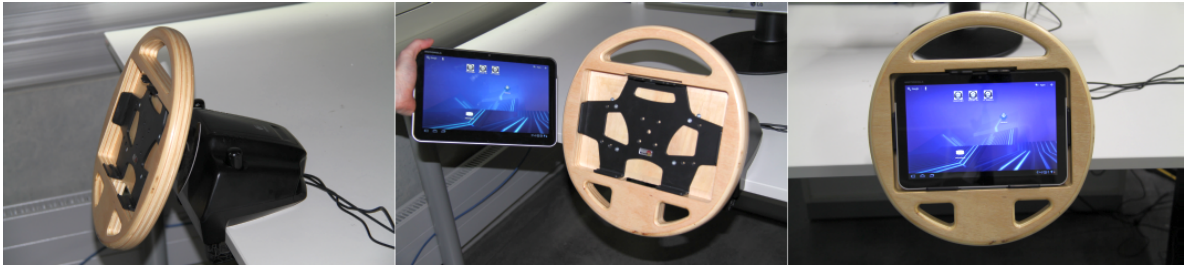
Abbildung 4.1.: Eigengefertigtes Holzlenkrad auf einem Logitech G27 Unterbau und der darin integrierte Android-Tablet-Computer
