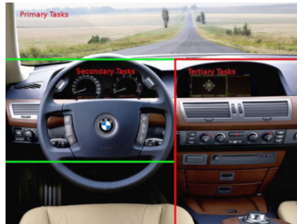
Abbildung 2.6.: Physische Aufteilung des Fahrzeugcockpits nach Aufgabenbereichen (Quelle: [60])
