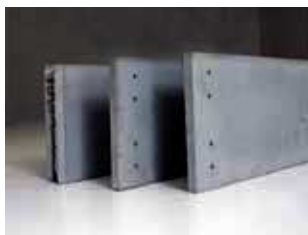
Bild 1.3: Bauteile aus Textilbeton, dünnwandige Konstruktionen, Basismaterialien
