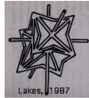
Veranschaulichung einer einzelnen Pore mit ein- springenden Zellstegen
