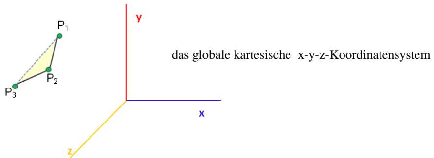
Abbildung 17: Eckpunkte eines Dreiecks der Reihe nach P1, P2 und P3 vor der Übertragung in eine der Ebenen, welche von den Achsen des globalen Koordinatensystems aufgespannt wird
