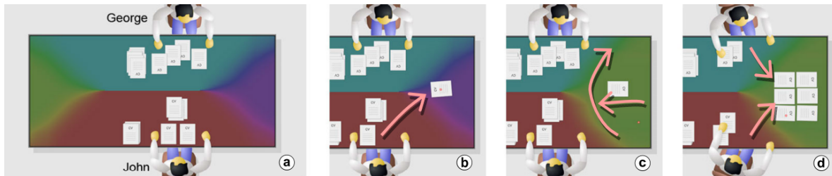
Abbildung 3.10: Anpassen der automatischen Ausrichtung durch Verändern des zugrundeliegenden Vektor-Feldes
