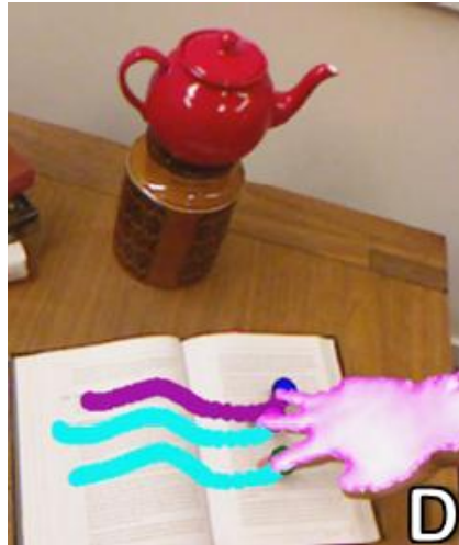
Abbildung 104: Handerkennung durch Differenzbild mit einem statischen Hintergrund (Izadi, et al., 2011).
