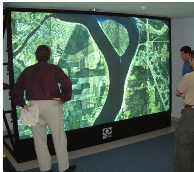
Abbildung 22: VisBlock - Powerwall aus 20 aneinander gefügte Bildprojektionen (VisWall, 2012).
