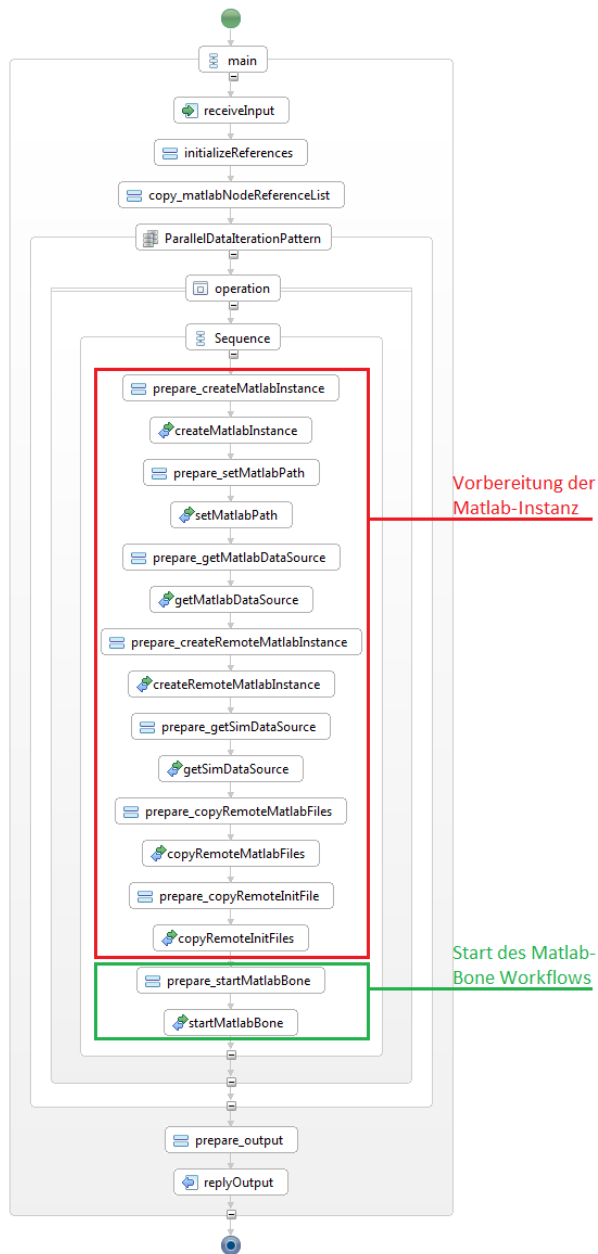
Abbildung 6.5.: Der überarbeitete Data-Manager Workflow inklusive dem parallelen Data Iteration Pattern
