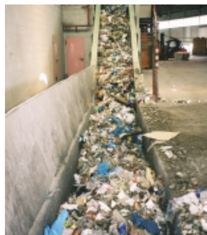
Abb. 6: Mix aus Hausmüll und Verpackungen, Materialaufgabe Sortieranlage (Karlsruhe).
