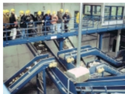
Abb. 5: Sortieranlage (Augsburg) zur Abtrennung von Leichtverpackungen.
