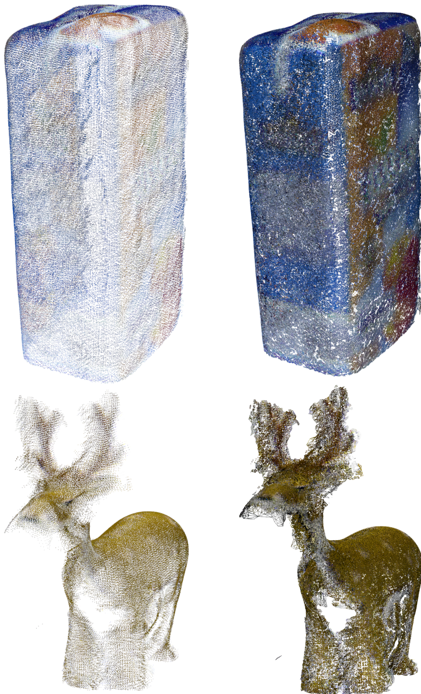
Abbildung 3.12: Polygonmodellerstellung mit Glättung der Punktwolke.
