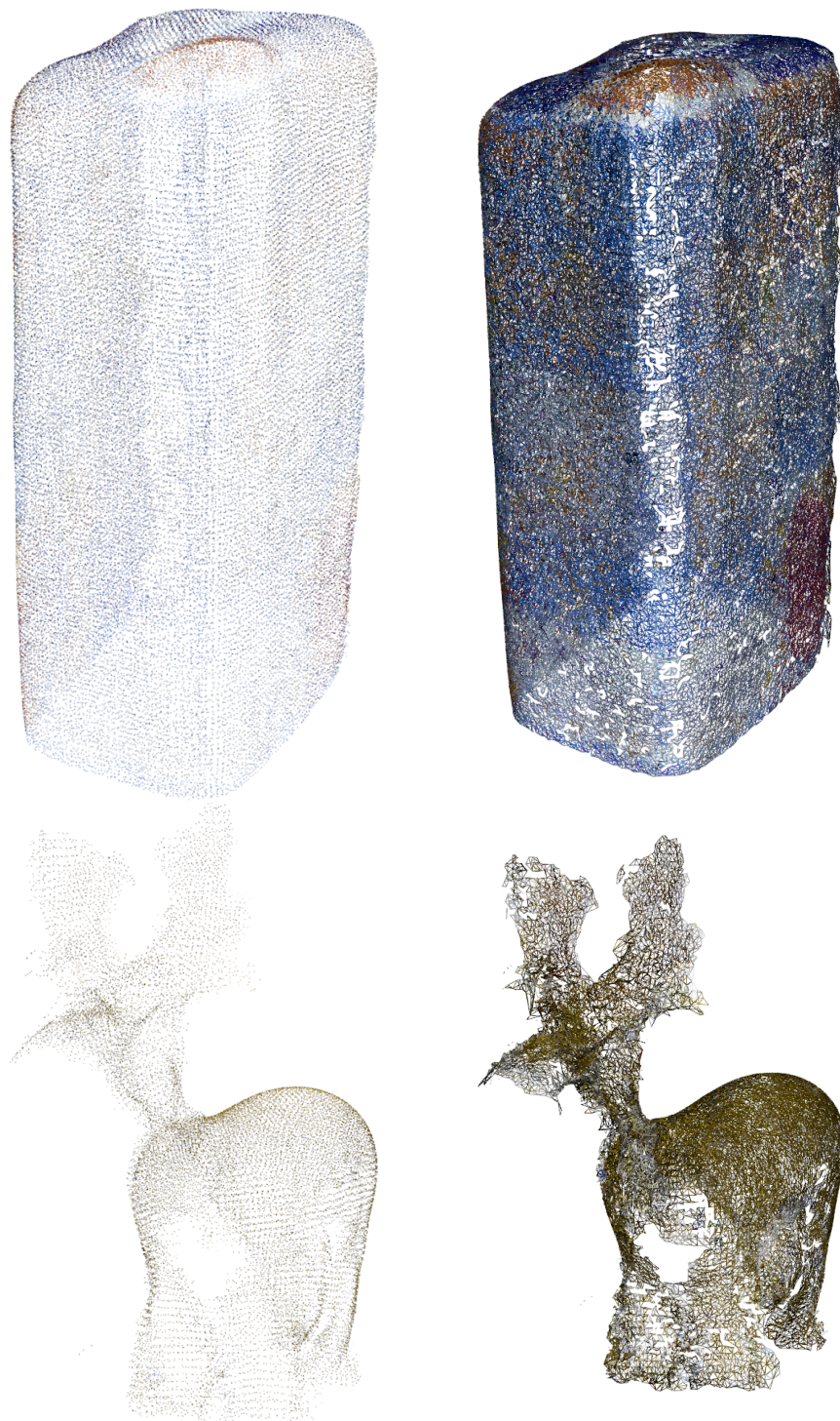
Abbildung 3.13: Polygonmodellerstellung mit Downsampling und anschließender Glättung der Punktwolke.
