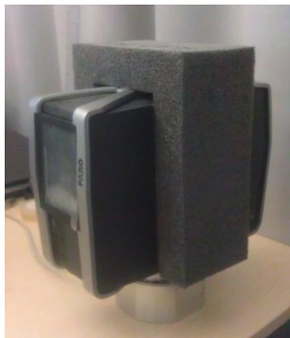
**Abbildung 4.1.:** Aufbau um die Dauer der Belichtungsmessung zu bestimmen. Auf den Scanner ist eine Schaumstoff-Haube gesteckt, die verhindert, dass Licht auf die Kamera fällt.
