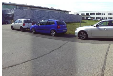
**Abbildung 2.5.:** Bei diesem Scan ist während der Aufnahme eine Wolke am Himmel vorbeigezogen und hat kurzzeitig die Sonne abgedunkelt. Die bei der Zusammensetzung der Einzelbilder entstehenden Farbanten sind deutlich zu erkennen.
