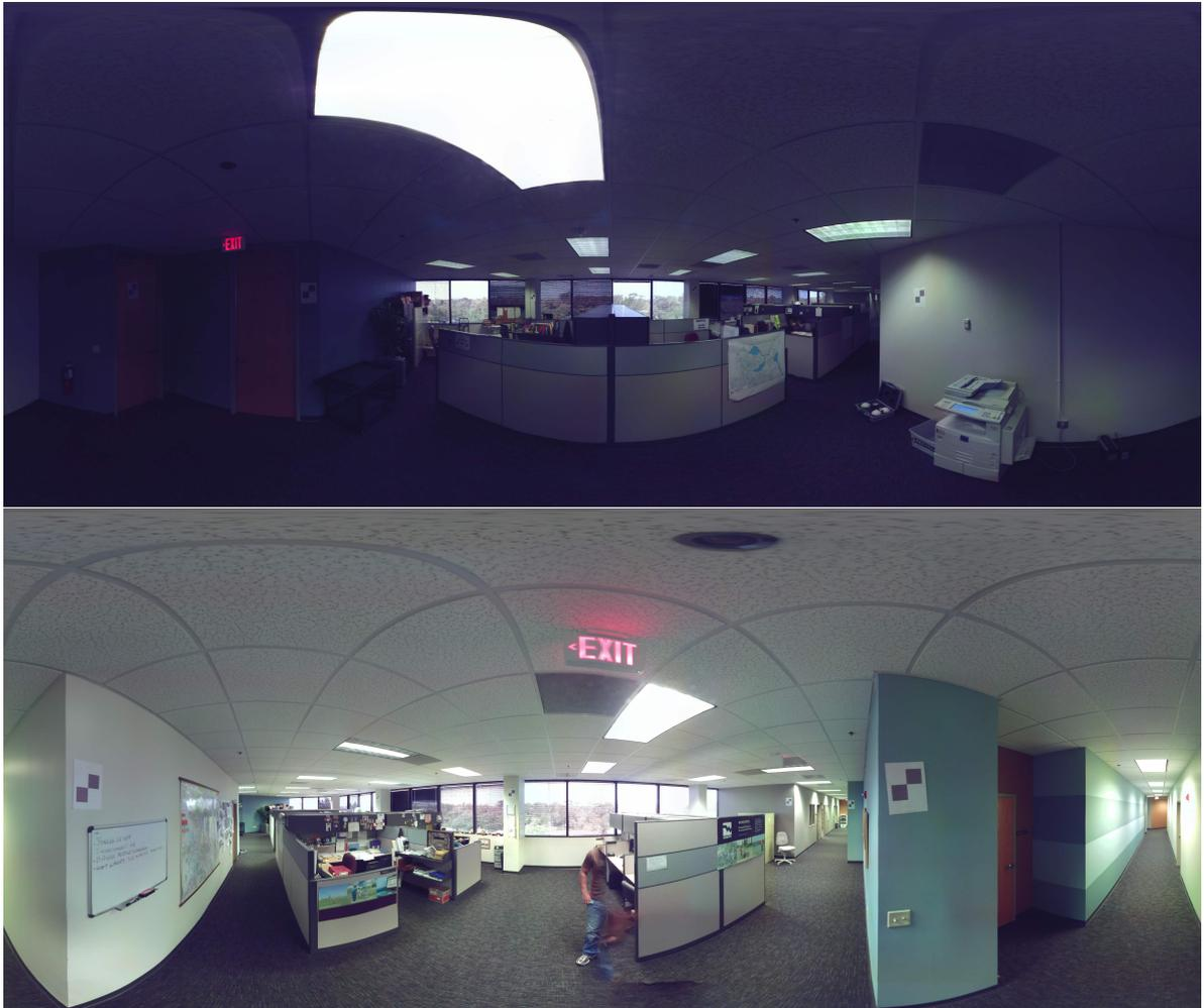
**Abbildung 3.4.:** Vergleich zwischen zwei Scans, bei denen Probleme mit der Bestimmung einer idealen Belichtungszeit aufgetreten sind. Beim oberen Scan wurde eine zu kurze Belichtungszeit bestimmt. Beim unteren Scan wurde eine korrekte Belichtungszeit bestimmt.
