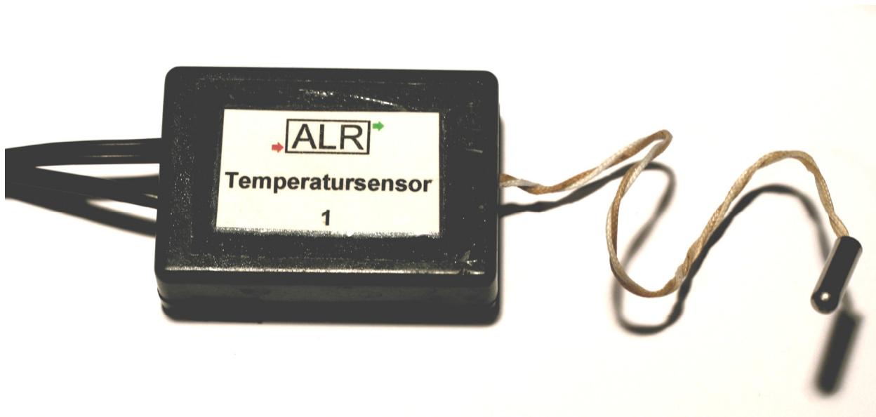
Bild 43: Ein fertig aufgebauter und eingehauster Sensor Rechts Sensor, links Elektronikgehäuse.
