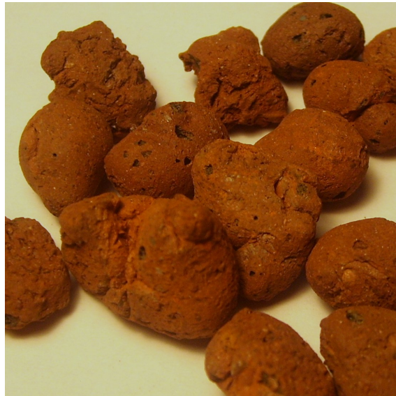
Bild 104: Habitus des ursprünglich als Filterpackung eingesetzten Blähtons
