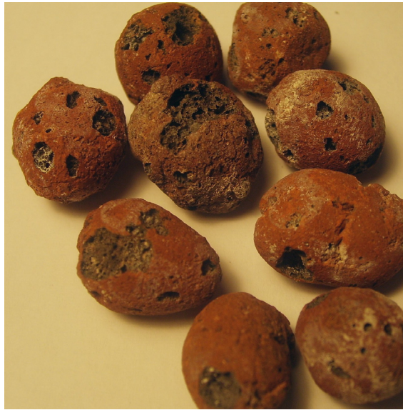
Bild 109: Reaktor 2, Filtermaterial am Ende des Regelbetriebs
