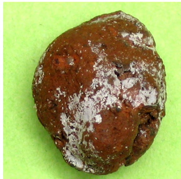
Bild 105: Habitus des Filtermaterials bei Beginn des Regelbetriebs
