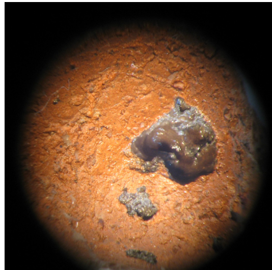
Bild 108: Reaktor 2, Habitus des Filtermaterial am Ende des Regelbetriebs
