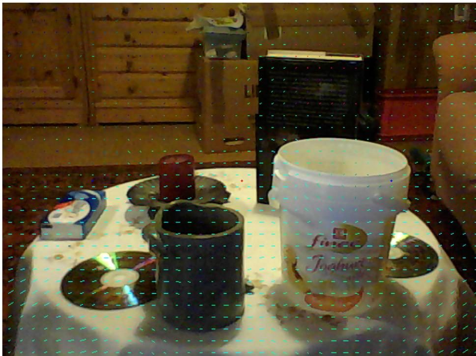
Abbildung 5.17: Optischer Fluss bei seitlicher Kamerabewegung. Aus dem Fluss können Rückschlüsse auf die räumliche Tiefe gewonnen werden. Die Flussermittlung gelang jedoch in einigen homogenen Bildbereichen nicht korrekt.
