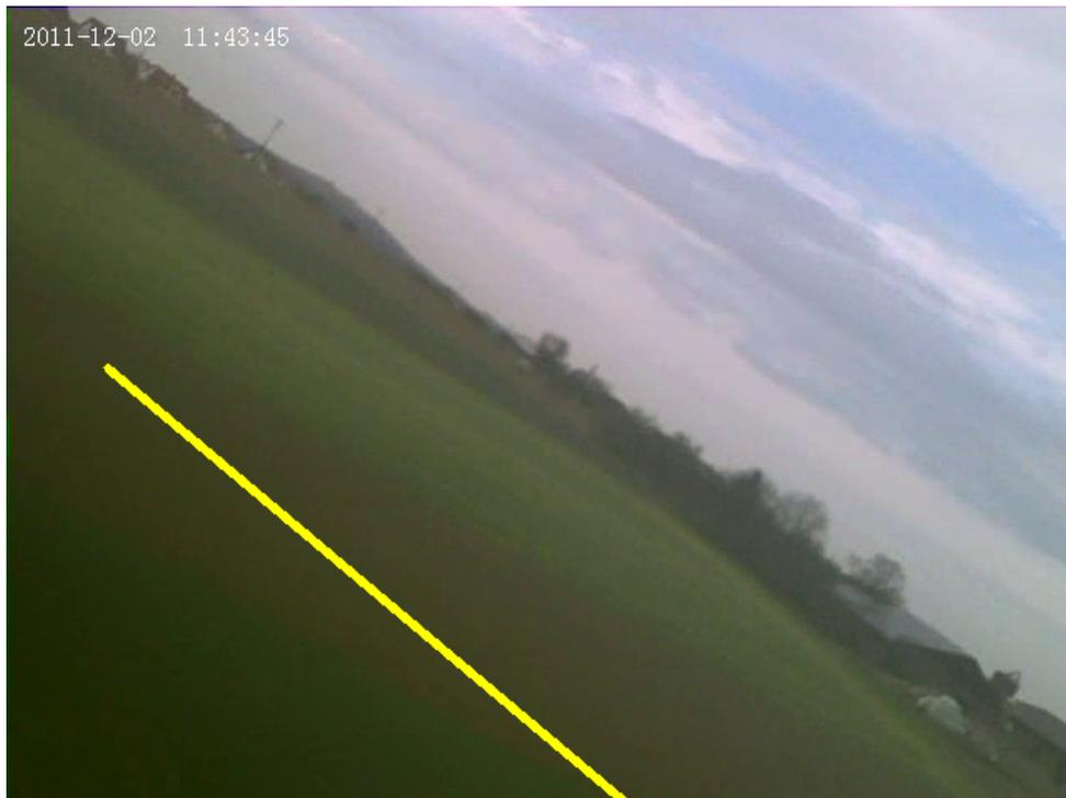
Abbildung 3.3: Ein ins Video eingeblendeter gelber Balken, der die Horizontlinie gemäß des künstlichen Horizonts wiedergibt, erlaubt die visuelle Synchronisierung von Video und Telemetriedaten.
