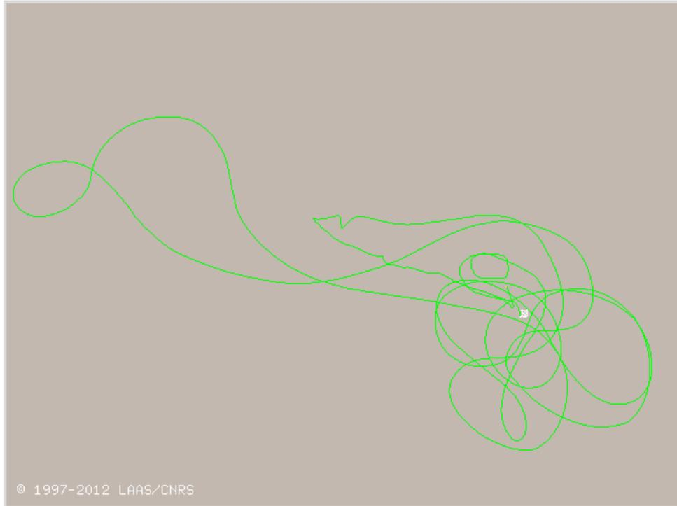
Abbildung 5.23: Visualisierung von RT-SLAM 3D Daten. Die Filterung basiert ausschließlich auf Positionsdaten des OpenPilot EKF, wenn die Kamera nur schwarze Bilder liefert.
