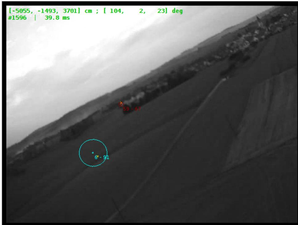
Abbildung 5.20: Visualisierung von RT-SLAM 2D Daten, Videobild mit erkannten Landmarken und deren Positionsvarianz.
