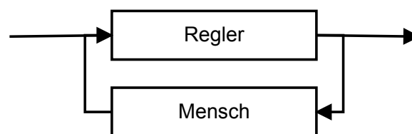
Abbildung 3.2.: Konzept zur Integration einer menschlichen Komponente in den Regelkreis
