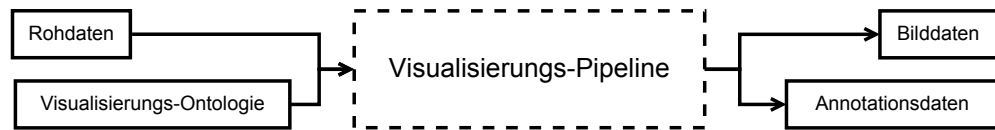
Abbildung 4.1: Die erweiterte Pipeline besitzt jeweils einen neuen Eingabe- und Ausgabeparameter: die Visualisierungs-Ontologie bzw. die Annotationsdaten.
