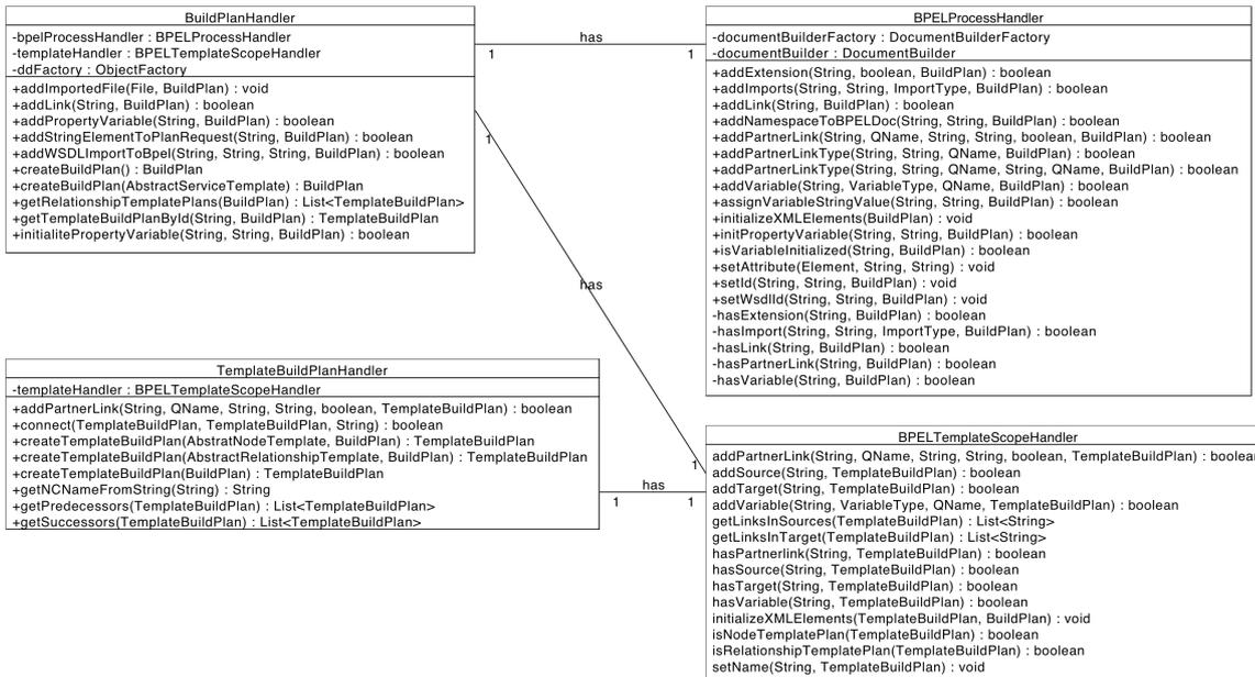
Abbildung 5.4: UML Klassen Diagramm der Fassade zwischen Modell und Planbuilder Komponenten
