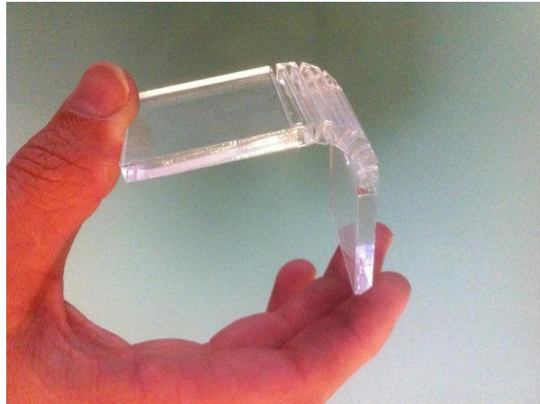
Abbildung 2.13: Durch das Entfernen von Material wird die Biegeeigenschaft ausgenutzt, um eine abgerundete Ecke zu ermöglichen. Quelle: http://blog.makezine.com/projects/creating-living-hinges/
