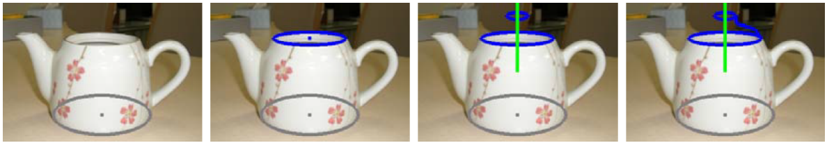
Abbildung 2.6: Das Foto dient zur Orientierung und wird verwendet, um einen Teedeckel für die Kanne zu erstellen. Durch das Festlegen einer Rotationsachse ist es ausreichend die äußere Kontur (rechtes Bild) des Deckels nachzufahren. Quelle: [LSMI10]
