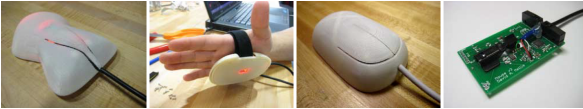
Abbildung 2.7: Die beiden Mäuse (links und Mitte links) entstanden im Rahmen eines Workshops innerhalb weniger Stunden. Die Maus in der Abbildung Mitte links verwendet Drucksensoren der Finger, statt der üblichen Tasten. Die beiden rechten Bilder zeigen den prototypischen Entwurf und die vorgefertigte Platine, die als Vorlage dienten. Quelle: [MB12]
