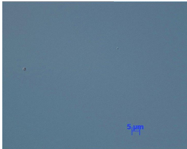
Abbildung 7.14: NDIC Aufnahme einer GeSn-Diode mit ionenassistentem Wachstum bei einer Wachstumstemperatur von T_{\text{sub}} = 300^\circ\text{C} während dem Wachstum der intrinsischen Zone.
