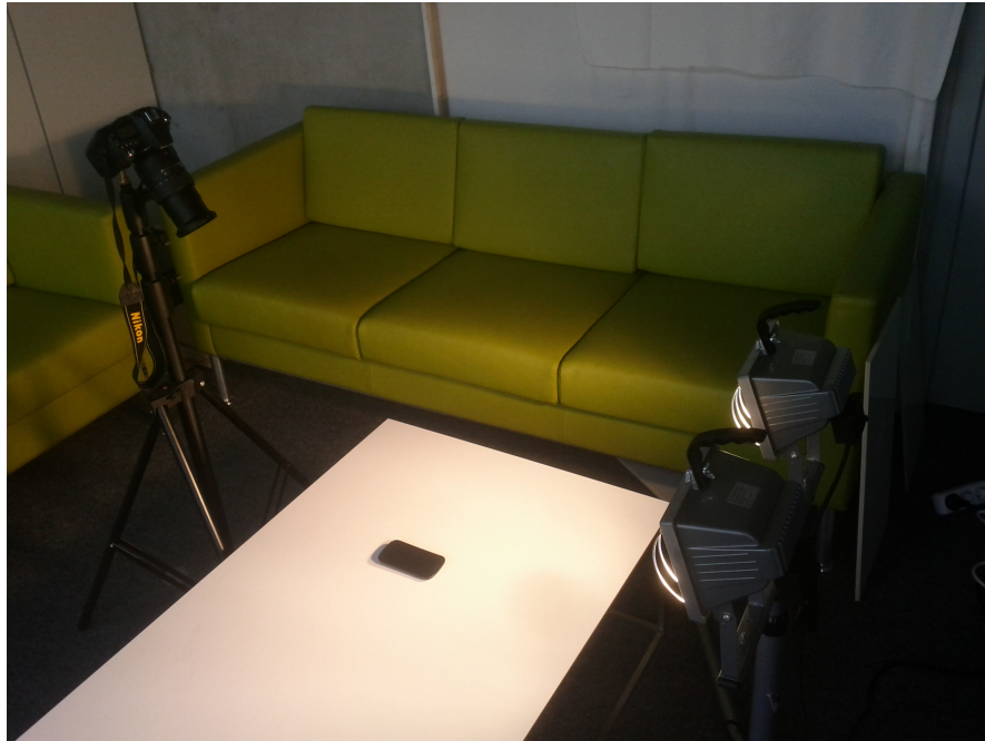
Abbildung 5.1.: Aufbau, der genutzt wurde um die Fotos der Fettspuren zu machen
