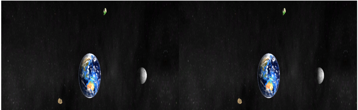
Abbildung 4.9: Side-By-Side-Technik: Links und rechts die Bilder, generiert von linker und rechter Kamera. Aus diesen Bildern kann der 3D-Bildschirm ein Bild erzeugen, welches durch eine Polarisationsbrille betrachtet den gewünschten 3D-Effekt im Gehirn hervorruft.
