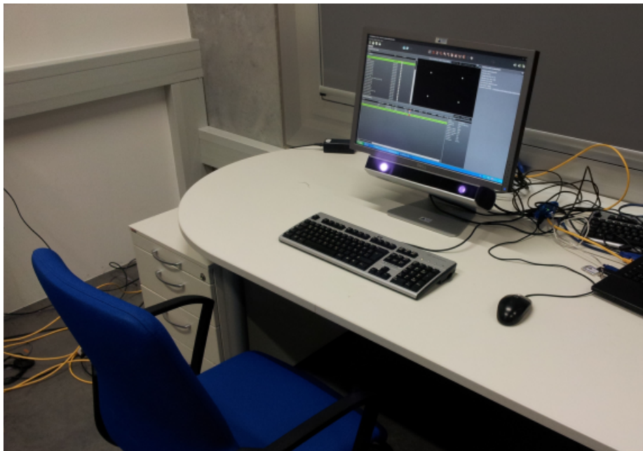
Abbildung 4.2.: Studiendurchführungsumgebung: Am Monitor angebrachter Eye-Tracker (RED 250) von SensoMotoric Instruments mit platzierter Tastatur und Maus stellt den organisatorischen Aufbau dar.
