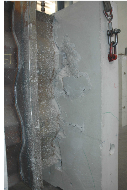
Abb. 4.24: Typisches Rissbild der BD2-Serie Abb. 4.25: Betonausbruch auf der Innenseite (weit im Nachbruchbereich)
