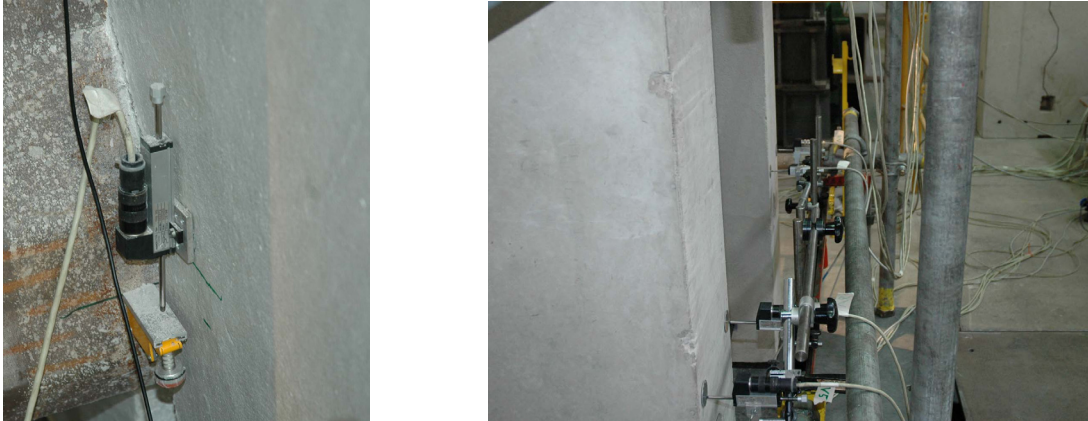
Abb. 4.5: a) Schlupfmessung zwischen Stahl und Beton b) Messeinrichtung für die Verdrehung bzw. das Spalten der Betonkörper
