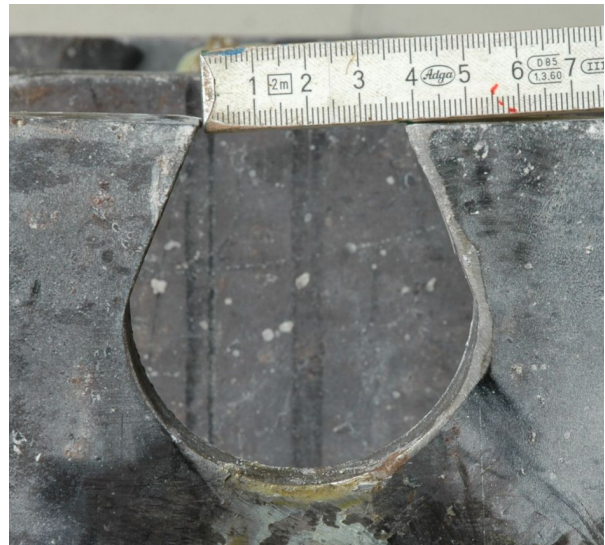
Abb. 4.47: Schließen des Dübels in der Zugsicke
