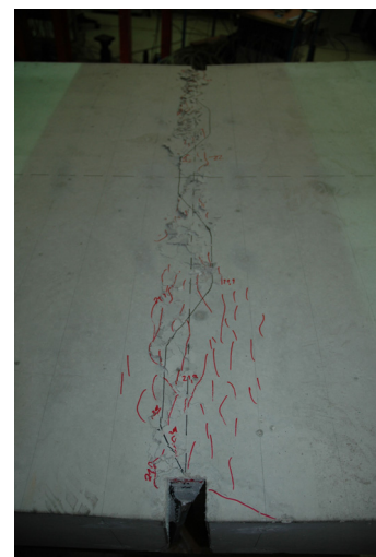
Abb. 4.42: Versagen der Druckzone bei R-Q2
