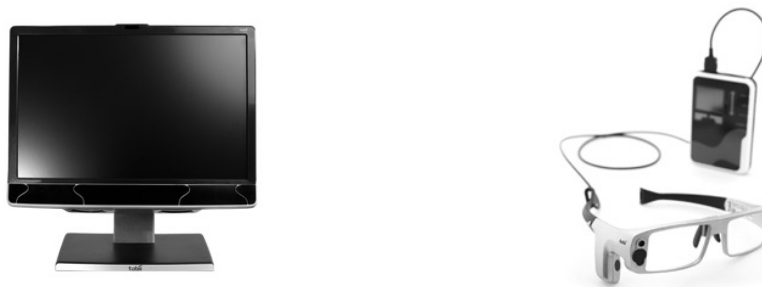
Abbildung 2.4.: Abbildungen von aktuellen Eye-Trackern der Firma Tobii. Quelle: tobii.com Links: Das stationäre Modell XL60. Rechts: Das Head-Mounted System WS619
