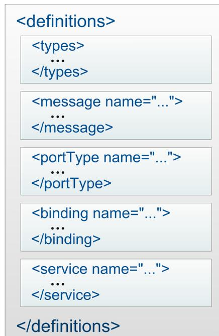
Abbildung 2.1.: Aufbau einer WSDL 1.1 [WCL<sup>+</sup>05]
