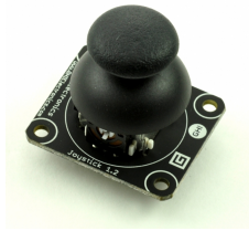
Abbildung 4.12: Gadgeteer Joystick Modul: Es kann die X und Y Richtung detektiert werden und ein klicken durch den Joystick.
