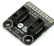
Abbildung 4.16: Extender Modul von Gadgeteer zum Anschluss von weiterer Elektronik durch 7 Anschlusspins und 3 Versorgungspins (3.3V, 5.0V und GND)
