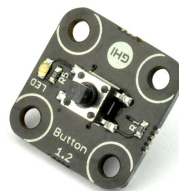
Abbildung 4.8: Gadgeteer Button Modul mit eingebauter LED.
