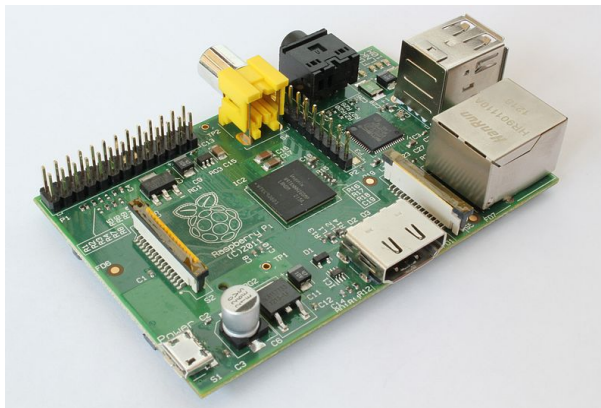
Abbildung 4.1: Raspberry Pi: kleiner kreditkartengroßer Rechner mit USB und HDMI Anschluss. Es können Linux und Node.js darauf installiert werden. [Wik13f]
