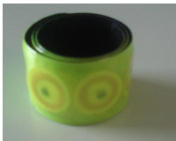
Abbildung 4.9.: Mit passiven RFID-Tags bestücktes Armband.
