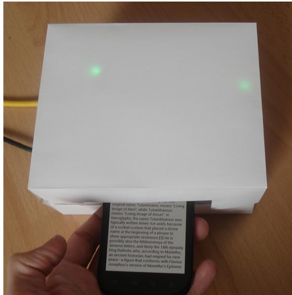
Abbildung 4.8.: Erster NFC Prototyp mit Öffnung für das Smartphone und LEDs.
