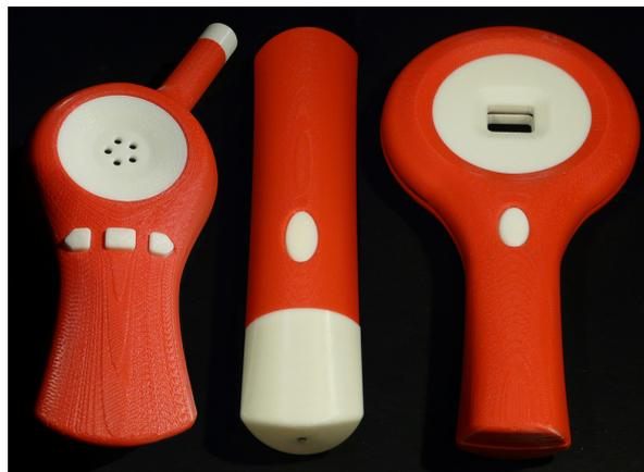
**Abbildung 2.6.:** TUIs für die Zeitreisenden von Links nach Rechts: Hörer, Zeigegerät und Lesegerät [WHM<sup>+</sup>09]
