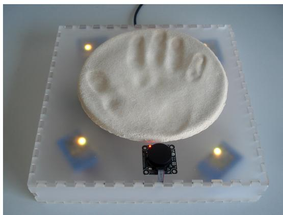
**Abbildung 3.2.:** Gadgeteer Prototyp für die Interaktion mit dem RFID-Armband.
