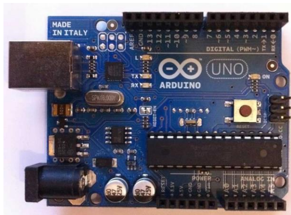
Abbildung 14 – Arduino Mainboard mit digitalen Ein- und Ausgängen, einem USB-Anschluss, einem 5V-Stromanschluss und einem ATmega328 Mikrocontroller. Quelle: Wikimedia.org 8
