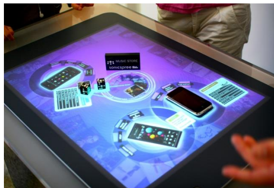
Abbildung 11 – Tabletop-Computer PixelSense der ersten Generation von Microsoft im Einsatz. Benutzer können Objekte mit Tags versehen und sie auf die Oberfläche legen. Das System zeigt dazu passende Zusatzinformationen an. Quelle: Wikimedia.org 3
