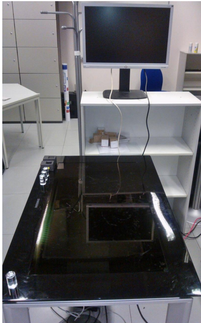
Abbildung 55 – Aufbau der Evaluationsstudie. Den Probanden stehen sechs Tangibles zur Verfügung. Zwei active Tangibles und drei passive Tangibles (als Gruppe am Rand des Tabletops platziert) und ein Information-Tangible (einzelner Plexiglaszylinder im Vordergrund). Ein externer Monitor ist an den Tabletop-Computer angeschlossen und kann über das Information-Tangible angesteuert werden.
