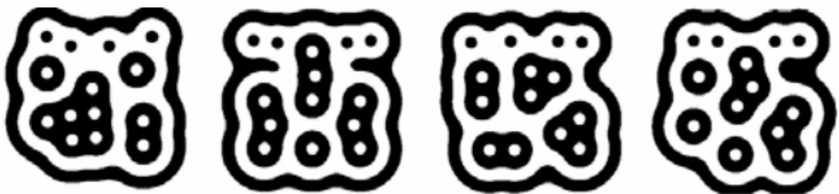
Abbildung 19 – Vier verschiedene Marker-Typen stehen für Objekte zur Verfügung. Diese sind an der Unterseite angebracht, sodass eine Kamera die Marker erfassen und das System Verbindungen zwischen kompatiblen Objekten erstellen kann. Quelle: [22]
