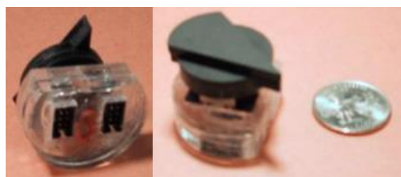
Abbildung 21 – Auf dem linken Bild ist ein Puck zu sehen, dessen obere zwei Anschlüsse mit einem Drehregler gekoppelt sind, während die unteren beiden noch frei sind. Im rechten Bild ist derselbe Puck zusehen mit US-Cent Münze zum Größenvergleich. Quelle: [23]
