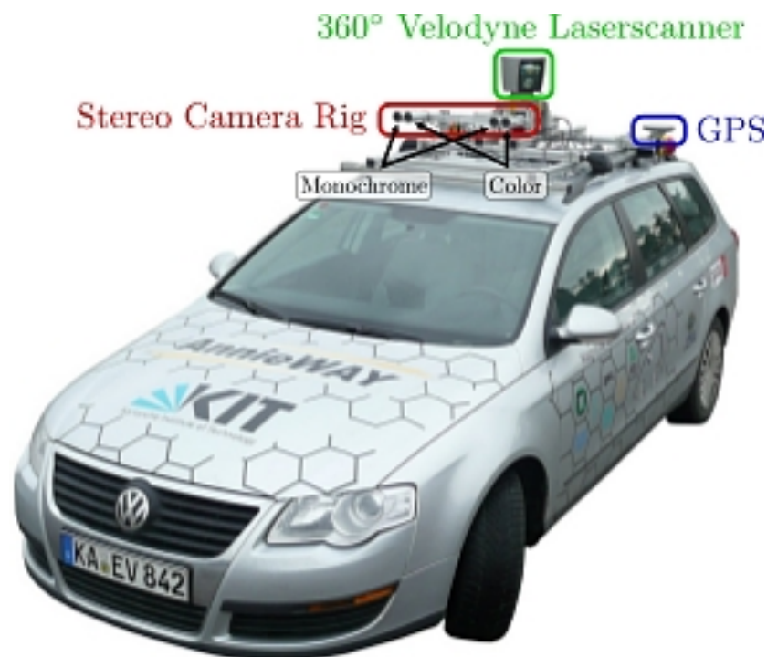
Abbildung 2.5: Der Kombinationskraftwagen, der zur Aufnahme der Daten für KITTI-Benchmark benutzt wurde [GLU 12 ].
