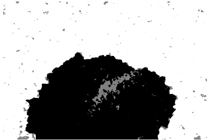
Abbildung 3.1: Trajektorienklassifizierung der Hydra-Sequenz (Unterabschnitt 2.3.3) mit polynomieller Regression vom Grad 2 und den Parametern T_a = 0.1, T_b = 0.05
