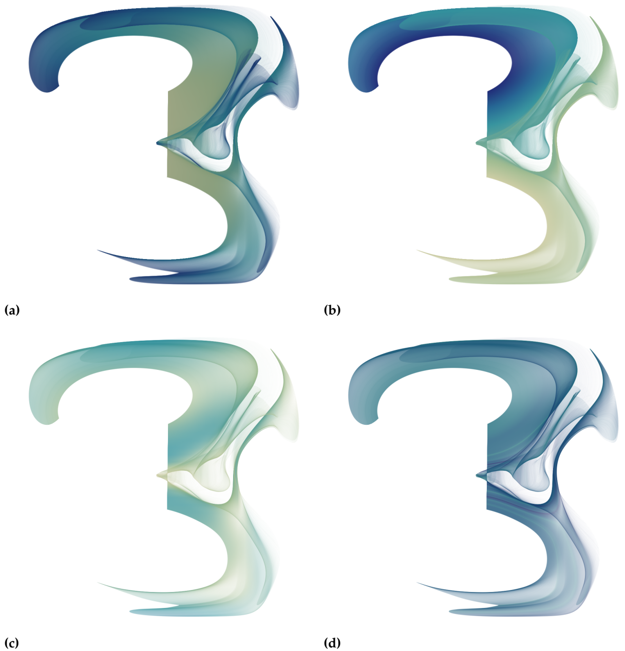
Abbildung 5.3: In Abbildung (a) wird der Farbverlauf anhand der Zeit dargestellt. In (b) wird den Linien ein Farbwert durch die Startposition zugewiesen. In (c) wird die Strömungsstärke durch den Farbwert dargestellt und in (d) der FTLE-Wert von der Startposition der Linien.
