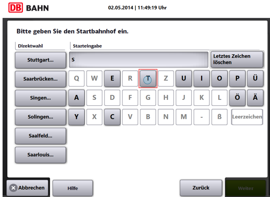
Abbildung 3.10: Diese Darstellung zeigt die Auswahl von Stationen mit den Fahrkartenselbstbedienungsgeräten der Deutschen Bahn. Dazu wird der Name der Station über eine Tastatur mit einzelnen Tasten für jeden Buchstaben eingegeben.
