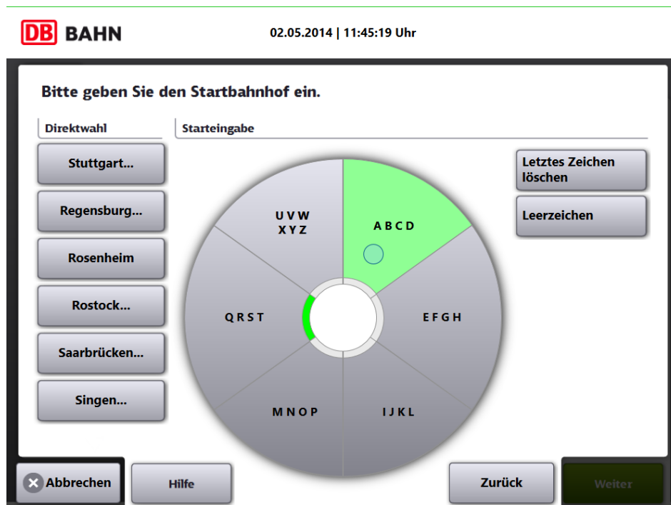
Abbildung 3.11: Diese Abbildung zeigt die für Gesten angepasste Variante der Auswahl von Stationen mit den Fahrkartenautomaten der Deutschen Bahn. Hierbei wurde die gewöhnliche Tastatur durch eine Tastatur mit weniger Tasten ersetzt. Hierbei stehen die Kuchenstücke der Tastatur jeweils für mehrere Buchstaben. Hierdurch muss weniger genau gezielt werden.
