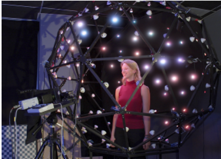
Abbildung 2.3.: Die “Light-Stage 3” von Debevec et al. erzeugt eine einfallende Beleuchtung mit Hilfe zahlreicher computergesteuerter Lampen (Bildquelle: [DWT + 02])
