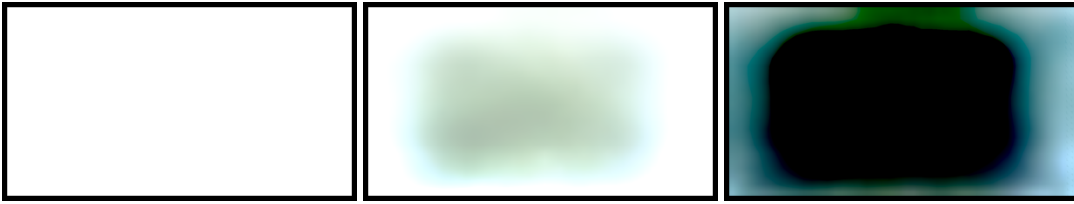
Abbildung 6.5.: Ausgabe vom HDR-Algorithmus: Eine uniforme Strahldichte ( L_r = 1 ) wird auf drei Frames verteilt. Man kann gut erkennen, dass in den Randbereichen mehr Licht erzeugt wird als in der Mitte, da der Bildschirm dort eine niedrigere maximale Strahldichte L_{255} besitzt (siehe Abbildung 4.9).
