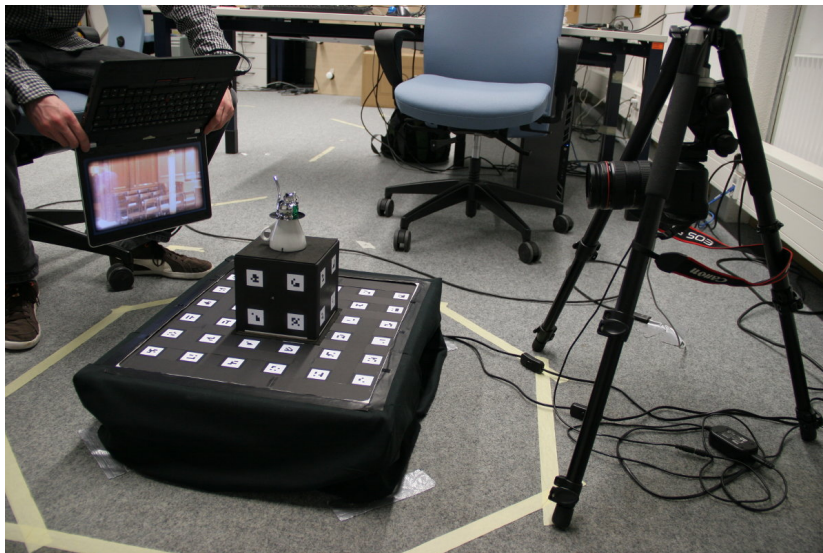
Abbildung 6.9.: Haltung des Benutzers bei der Beleuchtung: Die Tracking-Stage wird auf dem Boden aufgebaut, wodurch eine Sitzende Position möglich ist. Der Benutzer kann die Arme dabei auf den Knien aufstützen, sodass der Bildschirm sehr ruhig gehalten werden kann.
