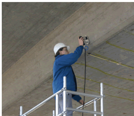
Abbildung 1.1: Überwachung am Bauwerk, links: „Visiting inspector“, Klangprüfung einer Nietverbindung im Stahlbau um 1930 [Hine 1998], rechts: Impact-Echo-Prüfung an einer Spannbetonbrücke 2004.
