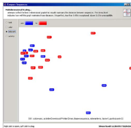
Abbildung 3.5: Abbildung der Ähnlichkeit von Fixations-Sequenzen. Mittels des Verfahrens der multidimensionalen Skalierung wird die Ähnlichkeit mehrerer Fixations-Sequenzen auf ein zweidimensionales Koordinatensystem abgebildet [WHRK06].
