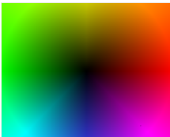
Abbildung 2.1: Die farbliche Darstellung des optischen Flusses. Der Farbton gibt die Richtung und die Helligkeit die Länge der Verschiebung an.
