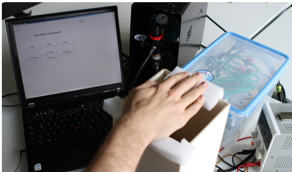
Abbildung 5.2.: Der Aufbau der Vorstudie im Überblick. Das Ausgabeprogramm mit den Antwortmöglichkeiten (links), der Kompressor (hinten Mitte), der Prototyp (hinten rechts), die Hand eines Probanden entkoppelt durch Schaumstoff auf der Holzturm-Testapparatur (vorne).
