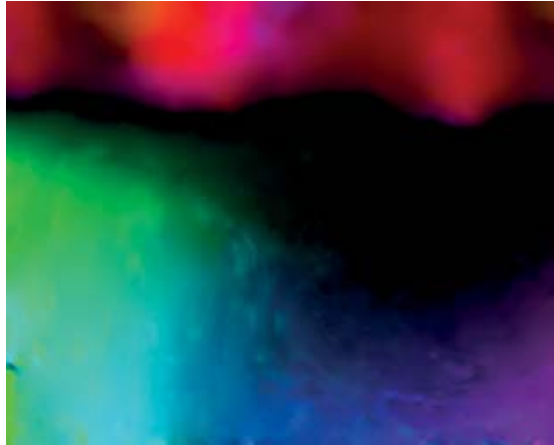
Abbildung 2.4: Optischer Fluss nach der Berechnung mit dem Horn und Schunck Verfahren. Lösung der Gleichungssysteme via SOR.
