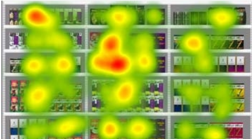
Abbildung 2.26.: Eine Heatmap: Je länger oder öfter ein Bereich des Stimulus betrachtet wird, desto wärmer ist die Farbe, die zur Markierung des Bereichs benutzt wird [Tobo8].
