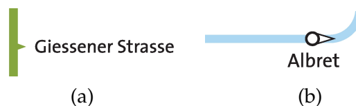
Abbildung 3.2.: Stationssymbole: a) Ein Bahnhof, an dem ein Verkehrsmittel immer anhält. b) Das Verkehrsmittel hält nur an, wenn es in Richtung des Pfeils fährt.
