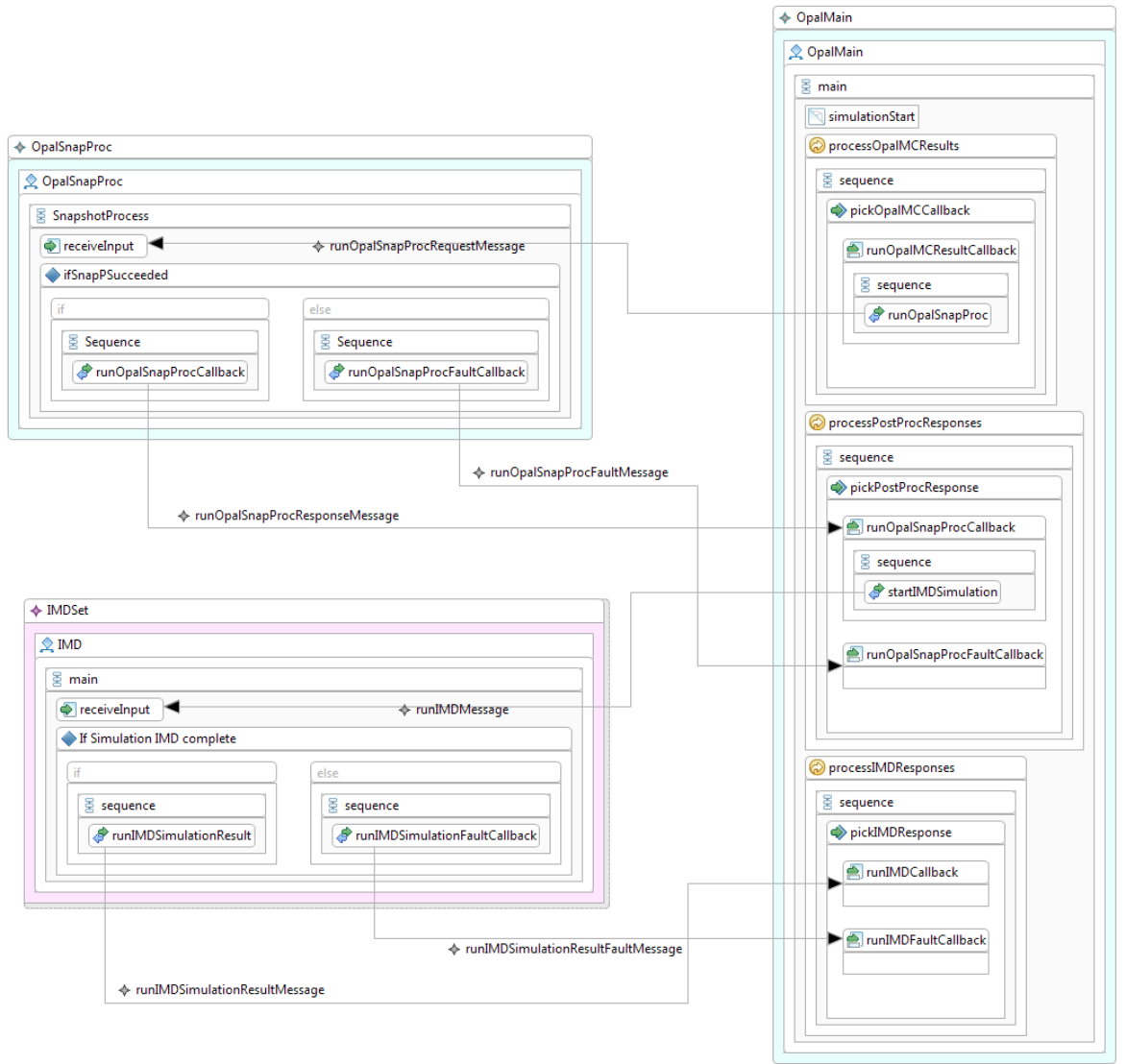
Abbildung 5.6.: Choreographie der gekoppelten Festkörpersimulation zur Analyse der thermischen Alterung von Festkörpern und deren Auswirkung auf das Werkstoffverhalten
