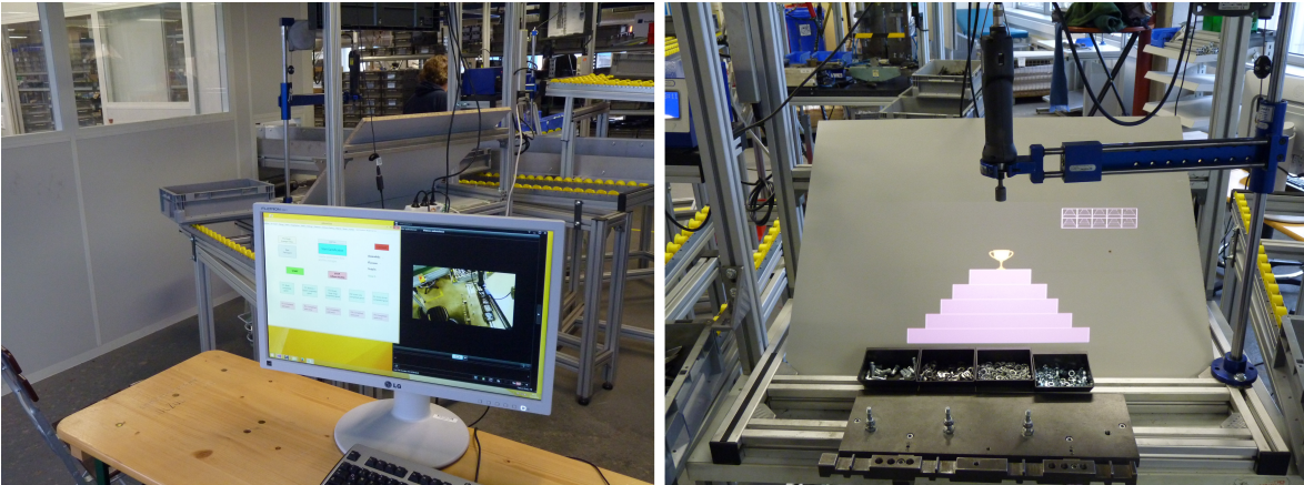
Abbildung 8.2.: Links: Sicht des Experimentators bei der zweiten Studie mit der Benutzeroberfläche des Wizard-Of-Oz-Programms und die Aufnahme der Kamera auf dem Bildschirm. Rechts: Die anfängliche Projektion vom Gamification-Ansatz: Graue quadratische Pyramide mit dem Pokal als Belohnung
