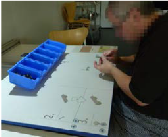
Abbildung 2.5.: Die Montage eines Legoautos wird durch den Einsatz des Assistenzsystems ASLM unterstützt. Quelle: [KSH13b].
