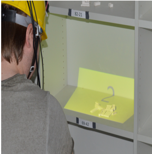
(a) Korrekter Entnahmepunkt mit der Darstellung der Anzahl, der zu entnehmenden Gegenständen.
