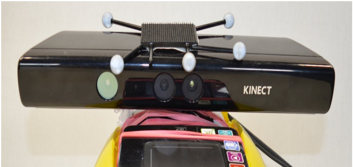
Abbildung 5.1.: Ausschnitt des Projektorhelms mit dem Fokus auf den Rigid Body.
