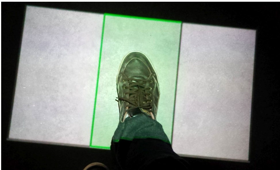
Abbildung 3.4.: Verfärbung der Interaktionszone bei erkannter Fuß-Interaktion.
