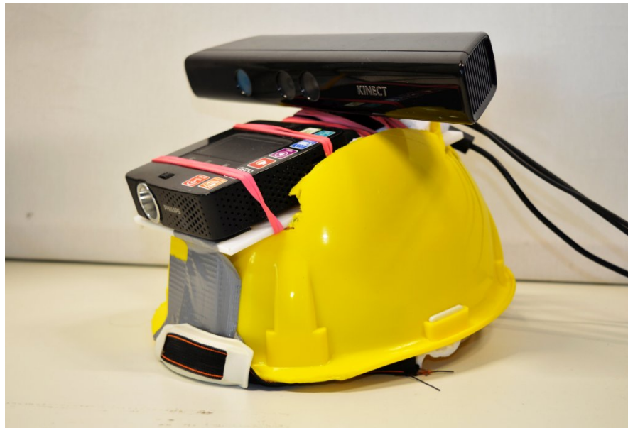
Abbildung 3.2.: Darstellung des konstruierten Projektorhelms.
