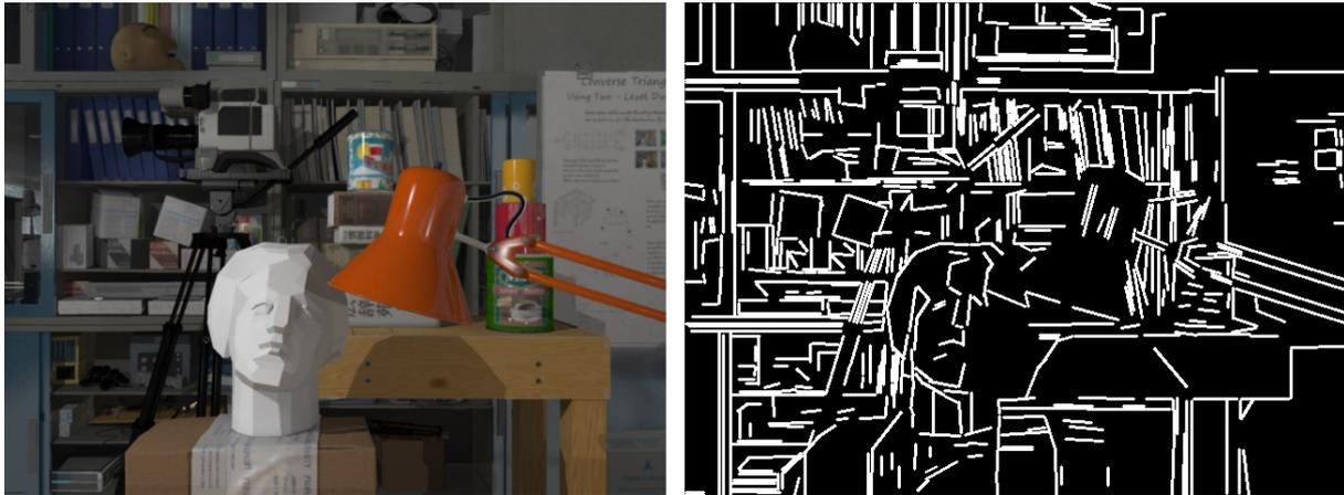
Abbildung 4.6: Von links nach rechts: (a) Aufnahme des neuen Tsukuba-Stereo-Datensatzes (vgl. Kap. 5.1). (b) Ergebnis des Liniensegment-Detektors in Standardkonfiguration ausgeführt auf (a).
