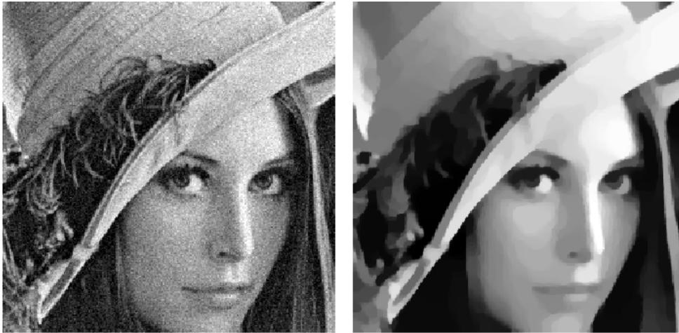
Abbildung 3.3: Von links nach rechts: **(a)** Verrauschte Aufnahme. **(b)** Rekonstruierte Aufnahme mittels ROF-Rauschreduzierung. Deutliche Glättung des Bildes unter Erhalt der Bildstrukturen. Quelle: <http://www.mathworks.com/examples/matlab/3636-total-variation-denoising> (Zugriff: 29.03.2015)
