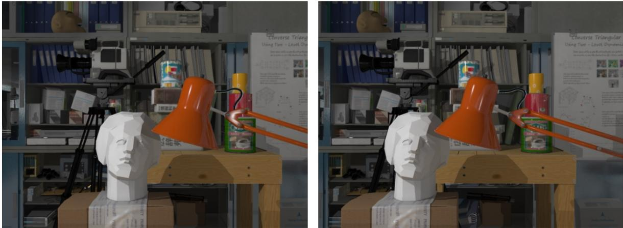
Abbildung 2.5: Stereoaufnahme des neuen Tsukuba-Stereo-Datensatzes (vgl. Kap. 5.1). Erkennbare Verschiebung der Objekte zwischen linker und rechter Aufnahmen. Vordergrundobjekte haben dabei eine größere Verschiebung als Hintergrundobjekte.
