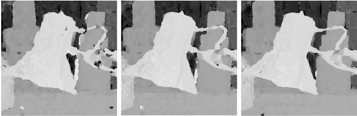
Abbildung 5.6: Auswirkungen verschiedener Anzahl an Eingangsbildern. Erkennbare Verbesserung der Tiefenschätzung mit zunehmender Anzahl an Eingangsdaten. Von links nach rechts: **(a)** Verwendung einer Sequenz bestehend aus 3 Einzelbildern. **(b)** Verwendung von 5 Eingangsbildern. **(c)** Betrachtung von 11 Einzelbildern zur Rekonstruktion.
