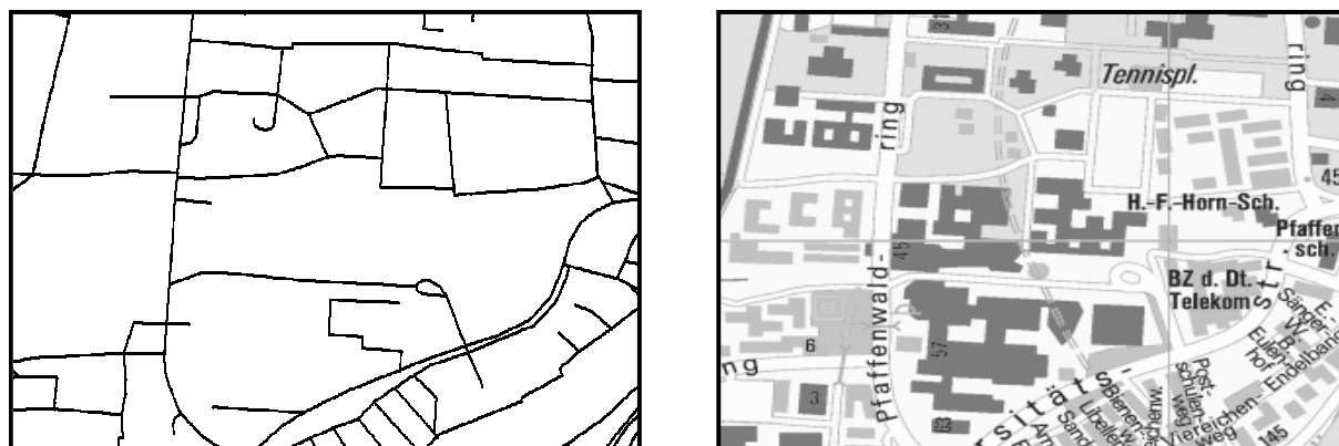
Abb. 3-1: Visualisierung des vektorbasierten GDF-Formats (links), Vergleich mit lageidentischem Stadtplanausschnitt
